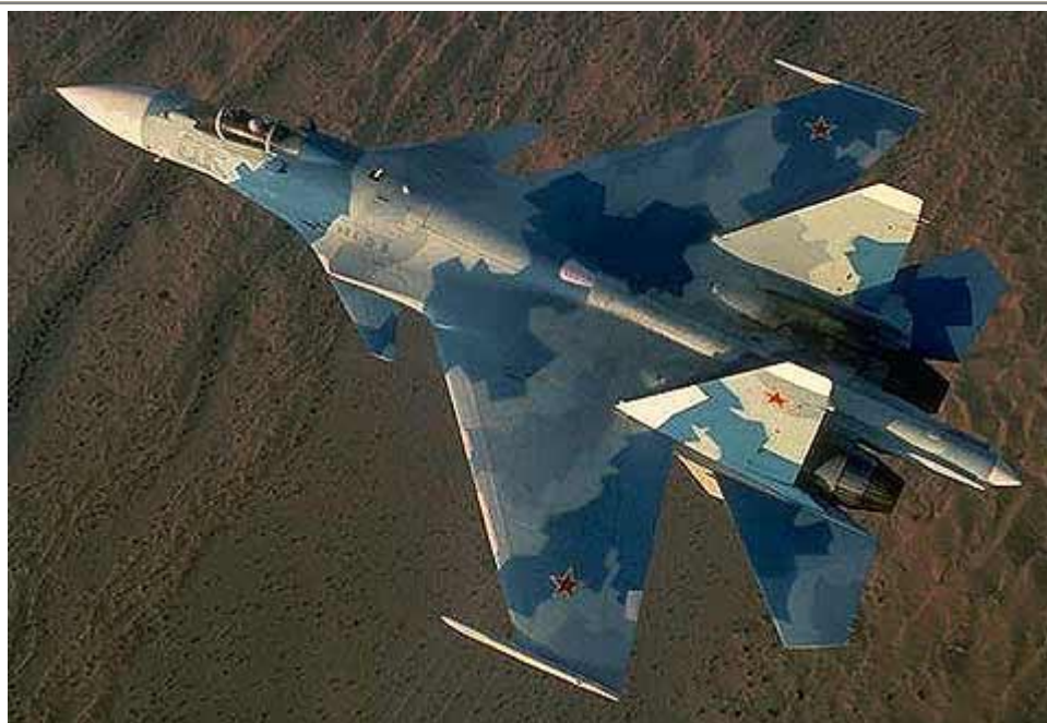
هواپيماي Su-37 Terminator به کانارد نيز مجهز است
