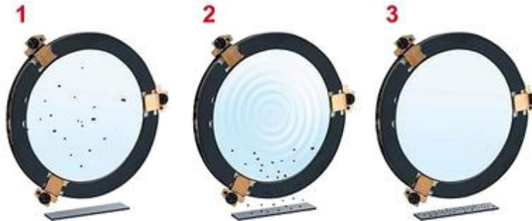
نحوه عملکرد سیستم Supersonic Wave Filter
