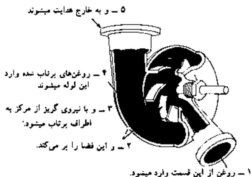
(شکل ۷ - ۲) پمپ گریز از مرکز و طرز کار آن
