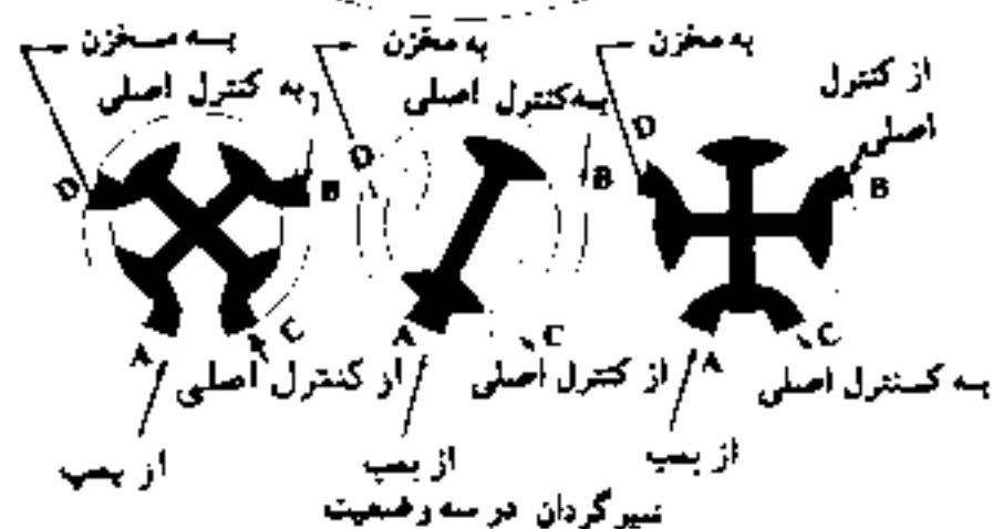
( شکل ۱۹-۲ ) شیر گردان و طرز کار آن
