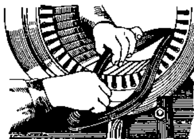
(شکل ۳۵-۴) یک استاتور در حال جاگذاری کلافهای سیم
